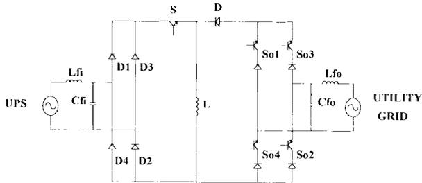
Fig. 5. Power-recycler circuit.
